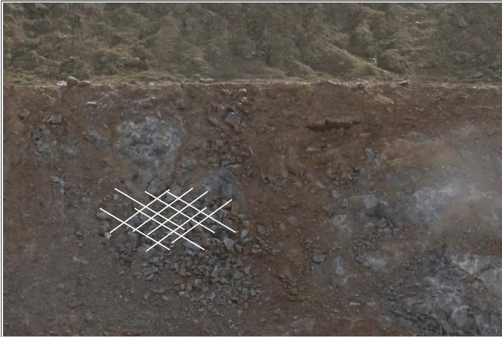
【그림 19】 D 영역 상세사진 (세편화된 암석)
